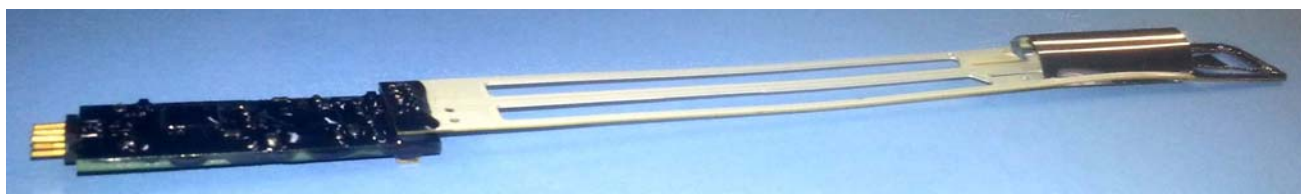
Рис. 3. Чувствительный элемент радиозонда (лицевой стороной вверх)
