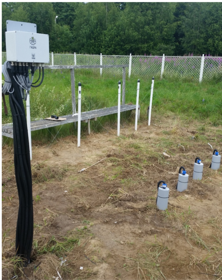
Рисунок 4 – Размещение датчиков температуры почвы на глубинах
